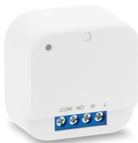
Das RF-Relais passt in jede Unterputz- oder Hohlwanddose. Besonders geeignet für die Steuerung von Elektroheizungen. Kann leicht mit unserem drahtlosen Thermostat THERM-520RF verbunden werden. Spannung: 230V AC / 50Hz, 16 (5) Ampere, 868.0-868.6MHz;
