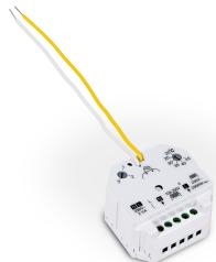
Der Funkempfänger ET-111C ermöglicht einfaches Schalten von elektrischen Heizgeräten sowie Fußbodenheizungen. Der Empfänger kann mit dem ET-14A die Raumtemperatur sowie in Verbindung mit dem Fernfühler ET-EF-111 auch die Fußboden temperatur steuern. Der Frequenzbereich 868 MHz garantiert eine große Reichweite und optimale Verbindung. Montage in UP-Dose, Schaltstrom: 10 A, Abmessungen: 50x47x33 mm, Schutzart: IP 20, Sendfrequenz: 868 MHz, Reichweite 100 - 300 m, CE konform.
