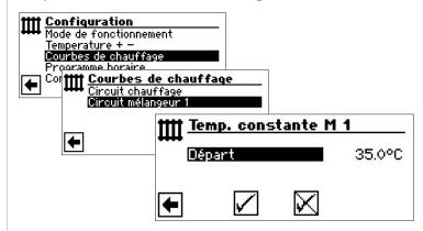
Si l'option « Température constante » est mise en service par le règlage système, l'écran passe dans le menu « Courbes de chauffage » (depuis lequel vous parvenez aux menus « Circuit mélangeur 1 », « Temp. constante M 1 »).
