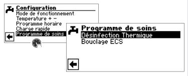
La désinfection thermique permet d'élever la température de l'eau chaude sanitaire à une température supérieure à celle que l'on peut atteindre avec une pompe à chaleur en utilisant un générateur de chaleur supplémentaire (ZWE). La désinfection thermique n'est préparée que via le générateur de chaleur supplémentaire ; le compresseur de la pompe à chaleur reste désactivé.
