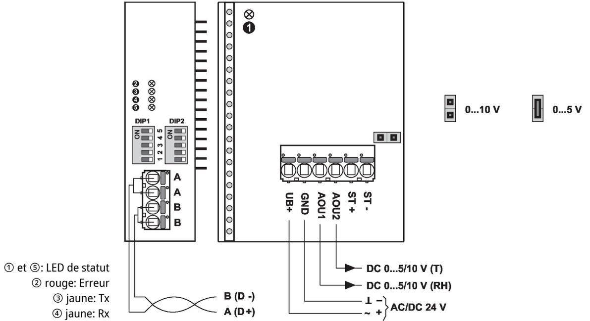
Les connecteurs ST+ / ST- sont uniquement utilisés pour les types de capteur qui disposent par ailleurs d'un élément de capteur de résistance passif pour la mesure de température. Le réglage des plages de mesure est effectué à l'aide de cavaliers. La valeur de sortie dans la nouvelle plage de mesure est disponible après 2 secondes.
