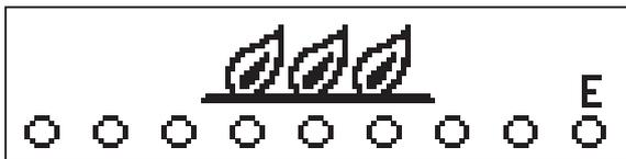
Drücken Sie die „+“- und die „-“-Taste gleichzeitig und mindestens 1 Sekunde lang. Der Kamin schaltet sich ein und im Fenster wird die Abbildung oben angezeigt. Sobald der Kamin gezündet hat, brennt dieser maximal und 8 der 9 Kreise in dem Fenster des Bedienpults leuchten auf.
