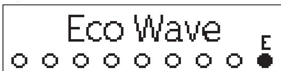
Drücken Sie die „+“-Taste einmal, um „Eco Wave“ zu aktivieren (hierbei wird davon ausgegangen, dass im Fenster 8 Kreise leuchten). Der Kreis bei „E“
