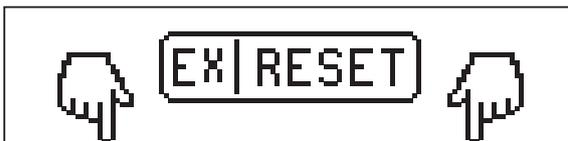
Wenn Probleme mit dem Zünden des Kamins vorliegen, wird ein Fehlercode mit einer Resetmeldung auf dem Display des Bedienpults angezeigt. Drücken Sie die „+“- und „-“-Taste auf dem Bedienpult gleichzeitig und mindestens 1 Sekunde lang, um den Kamin zurückzustellen. Versuchen Sie erneut, den Kamin zu zünden. Das System kann maximal zwei Mal nacheinander zurückgestellt und erneut gezündet werden. Danach schaltet das System auf Störung.
