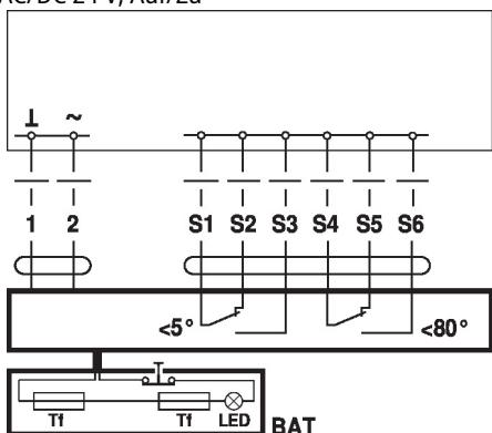
**Anschluss mittels Stecker an****Kommunikations- und****Netzgeräte:**
