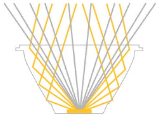
Lichtverspilling van traditionele Reflector
