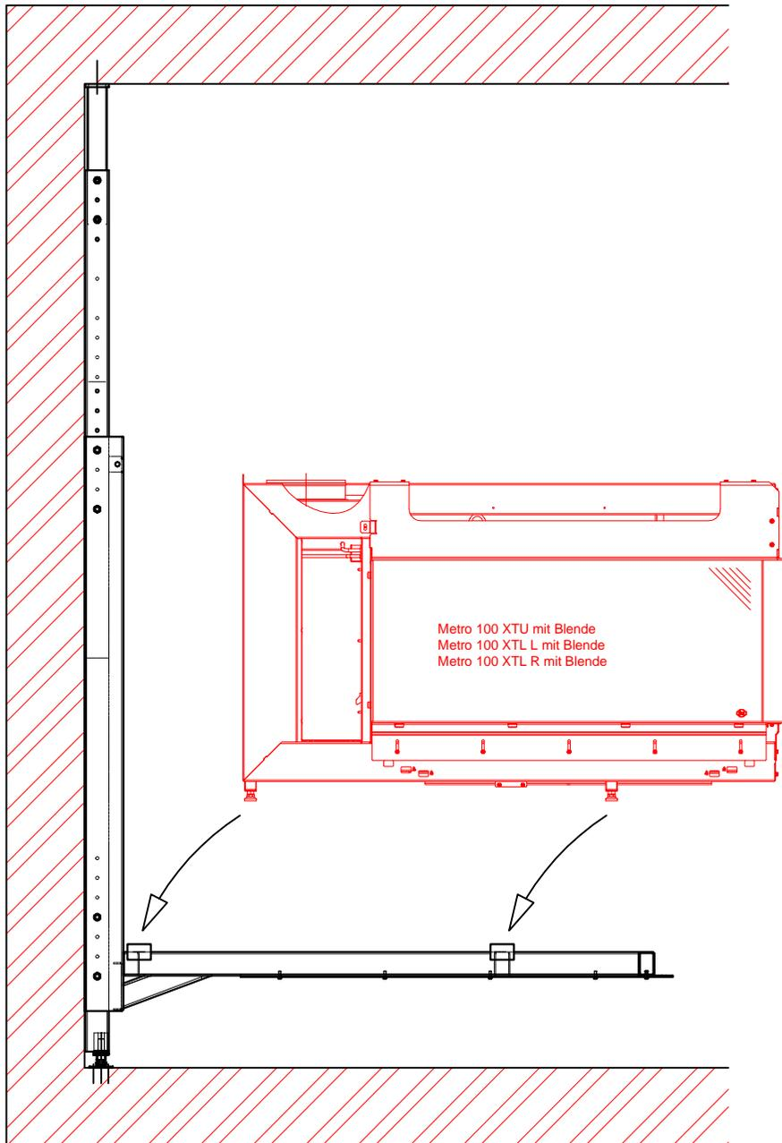
3) Zugstange zwischen Gestell und Gerät montieren.
