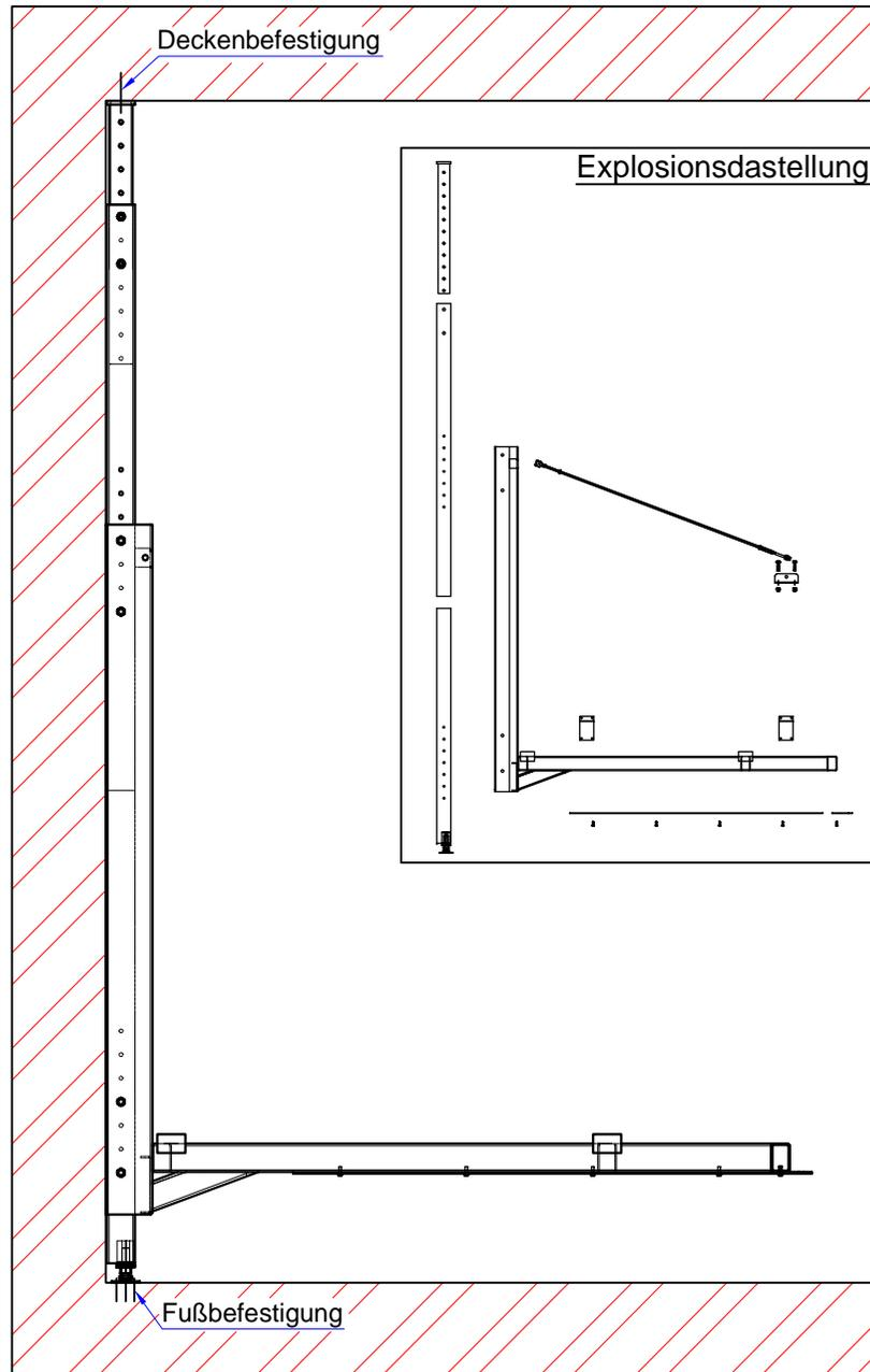
1b) Gestell aufstellen, ausrichten und an der Wand befestigen.
