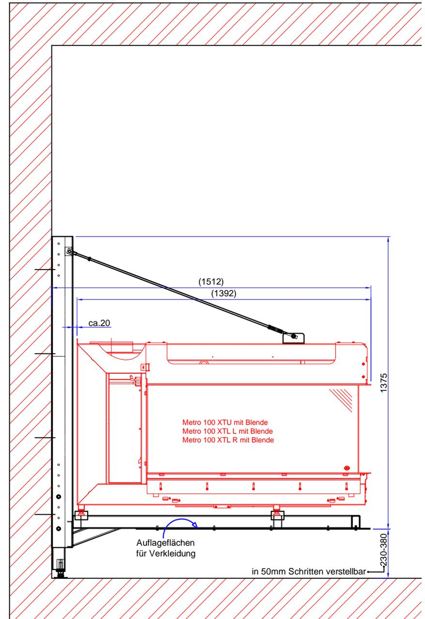
1a) Gestell aufstellen, ausrichten und an der Decke und Fußboden befestigen.
