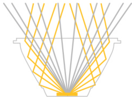
Lichtverspilling van traditionele Reflector
