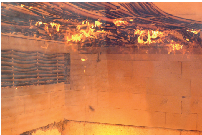
De JMV functiebehoud-systeemtest, E90 tot 1000° C.
