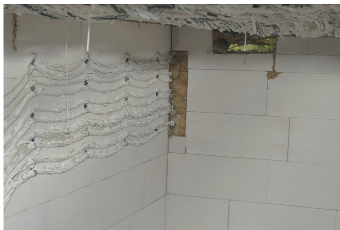
Het eindresultaat na 90 minuten functiebehoud-systeemtesten.
