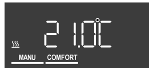
Bild 3: Anzeige der Soll-Temperatur im Handbetrieb
